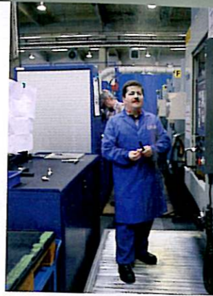
Podest: Dank des höhenverstellbaren Podests kann Johann Sirch das CNC-Panel seiner Maschine (re.) mühelos erreichen
